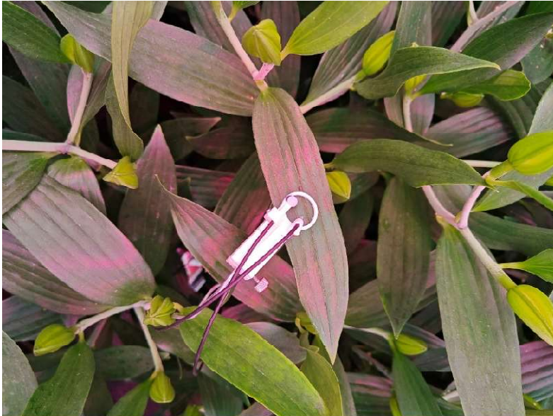
Figuur 4. Foto van de Sendot fotosynthesesensor vastgeclipd aan een lelieblad.
