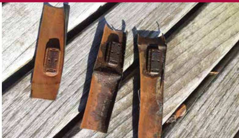
Figuur 1: links verstopt met ijzer, rechts een schone dripper.
