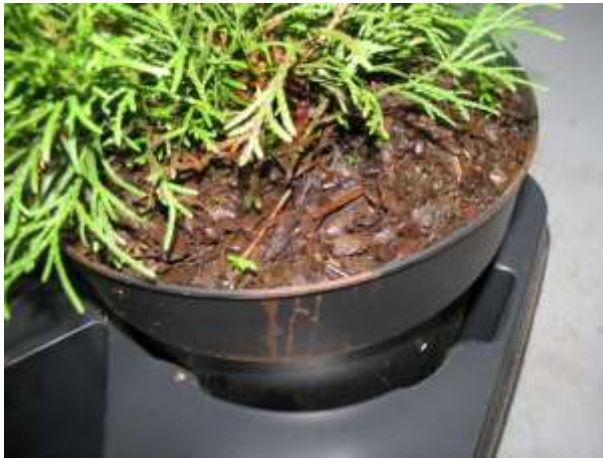
Figuur 33: De lijm voor fixatie is zichtbaar op de Biodeck heeft een bruine kleur.
