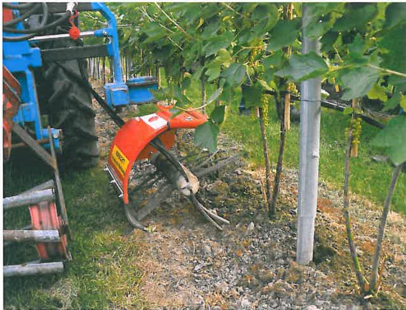
borstels voor mechanische onkruidbestrijding
